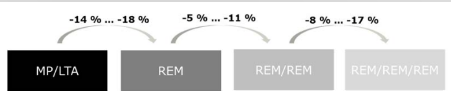
Kuva 15. Keskimääräiset kestoiän muutokset toistettaessa remix-toimenpiteitä.
