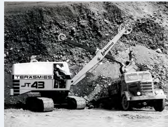
Lokomo aloitti Teräsmies-kaivukoneiden valmistamisen 1950-luvun lopulla. Vaijerikoneista suurin oli paineilmaohjauksella varustettu telaketjuaalustainen 44 tonnin kaivukone Lokomo JT 43.
