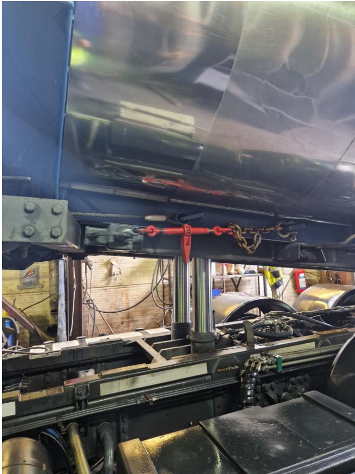
Positiivinen havainto. Vaihtolava-auton lavalukko varmistettu vanttikiristimellä
