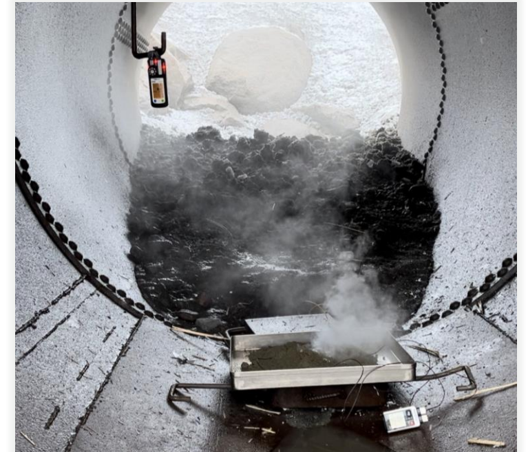
>> HPE reaktio pyriittiä sisältävän malmin kanssa
