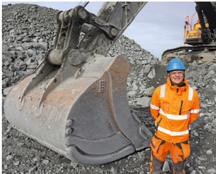
Jonne Ruopsa vierellään Volvo EC950FL:n kauha. Tilavuutta kauhalla on 6,5 kuutiometriä.
