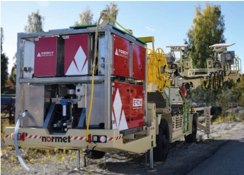
ECM3-2-pumppuinen tunnelipanostuslaitte sekä laitteen mukana tulevat pölypalvelut ml. Power BI-panostusraportti käyttöä Kivihammerin työmaalla*
